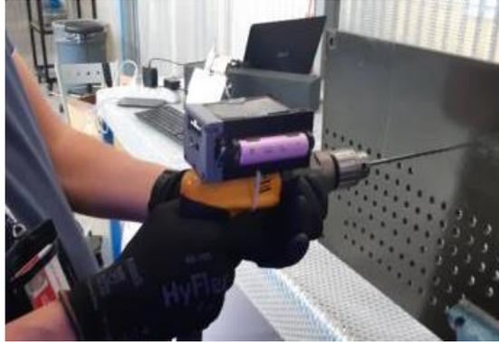
Figura 2 – Prototipo utilizzato per foratura composito
